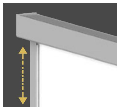
3 Manœuvre du store, pose des contre coulisses dans la bonne position et fixation finale par rivets.
