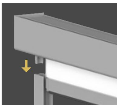
1 Pose des coulisses autoportantes et montage du coffre sur les coulisses.
